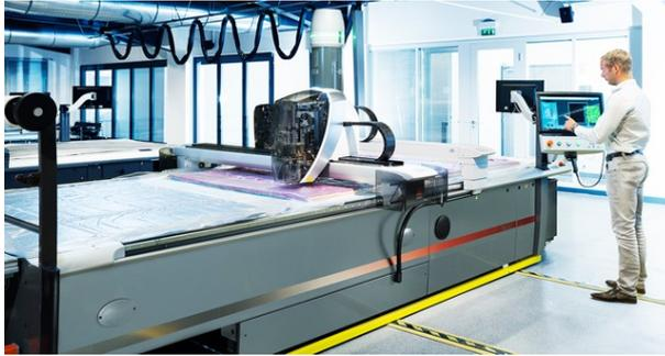
L'industriel a rapidement voulu travailler sur le suivi de la qualité du processus. Dotées d'environ 200 capteurs, les machines connectées en réseau analysent les tissus pour les découper suivant leurs caractéristiques (viscosité ou déformation sous la lame). C'est ainsi qu'elles adaptent l'angle du cutter en fonction de l'endroit où elles coupent dans le
